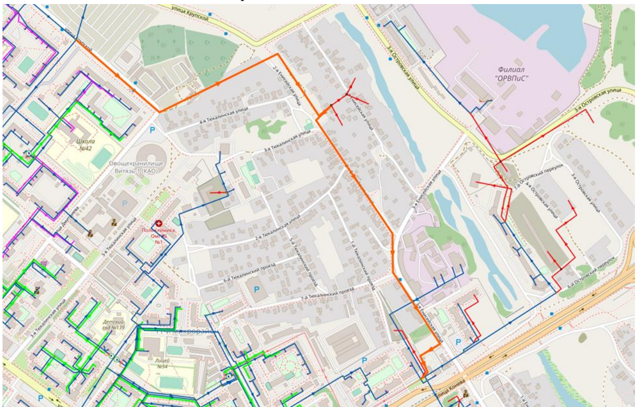
Рисунок 21. Схема трассировки трубопроводов тепловых сетей (обозначена оранжевым цветом) для подключения потребителей котельной 1.09 и части тепловой сети КРК к ТЭС-3
