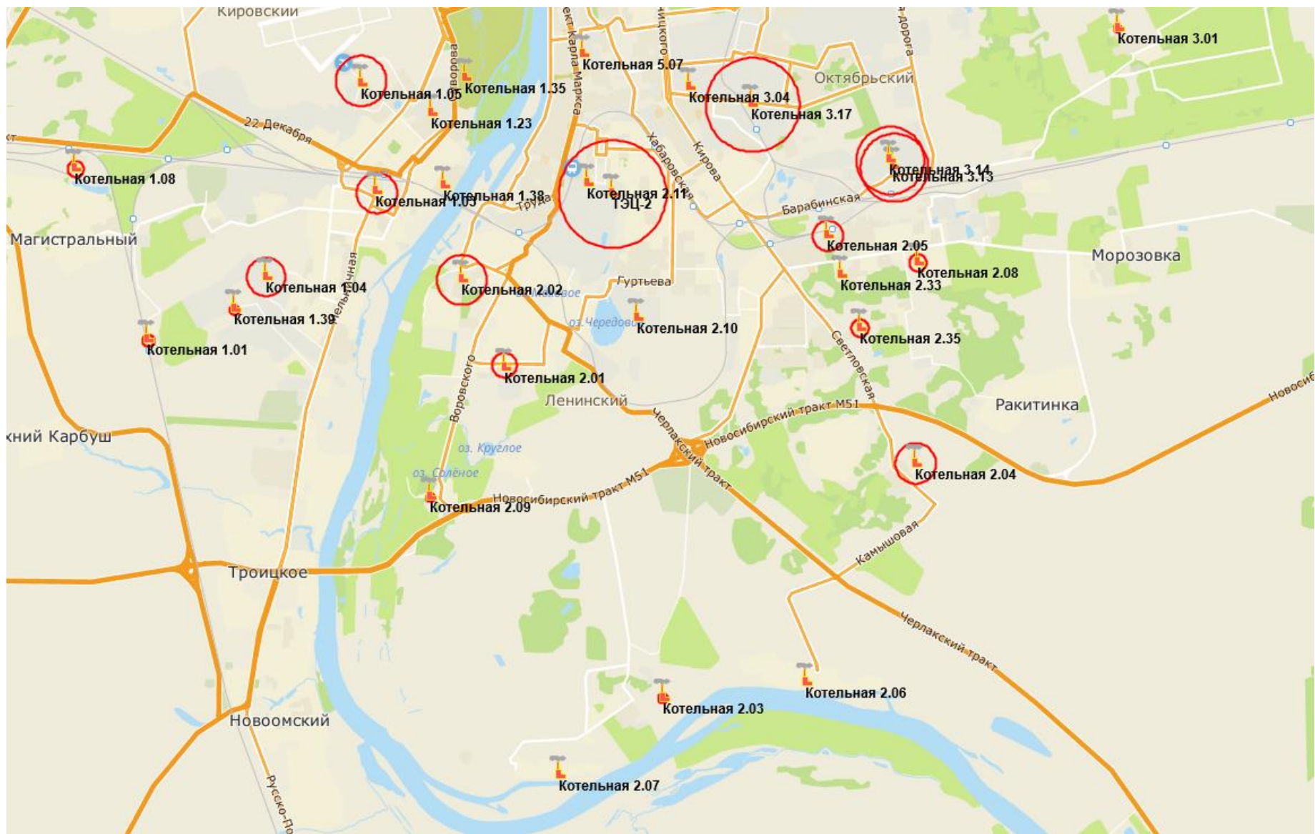
Рисунок 9. Области рассеивания вредных (загрязняющих) веществ с максимальной концентрацией от дымовой трубы (нумерация котельных в таблице 276)
