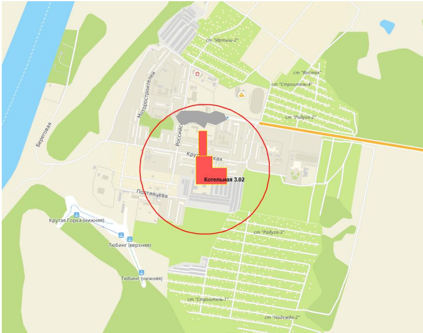
Рисунок 6. Области рассеивания вредных (загрязняющих) веществ с максимальной концентрацией от дымовой трубы (нумерация котельных в таблице 276)
