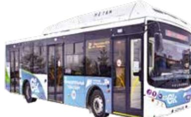
Общая пассажировместимость автобуса – 111 человек, мест для сидения – 28. Автобусы низкопольные, что позволяет пассажирам безопасно перемещаться по всей длине салона. Пневматическая система наклона кузова делает посадку и высадку из автобуса комфортной. С внешней стороны автобусы оборудованы кнопками вызова водителя.
