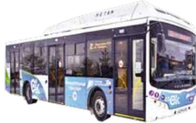
Общая пассажировместимость автобуса – 111 человек, мест для сидения – 28. Автобусы низкопольные, что позволяет пассажирам безопасно перемещаться по всей длине салона. Пневматическая система наклона кузова делает посадку и высадку из автобуса комфортной. С внешней стороны автобусы оборудованы кнопками вызова водителя.
